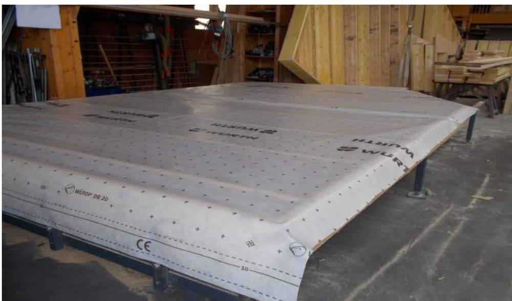
Caisson isolé et filmé d'une membrane d'étanchéité à l'air
