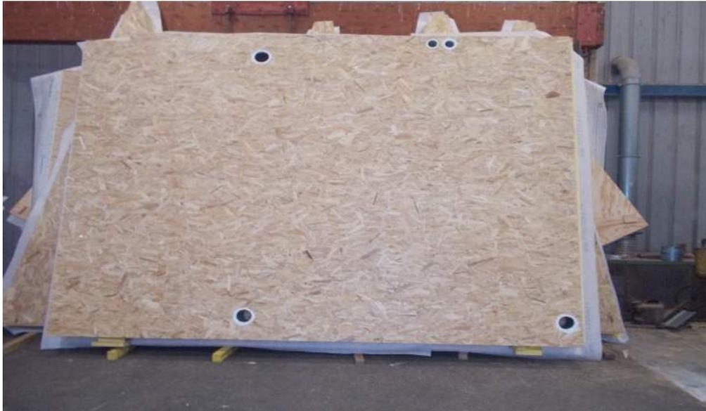
Caisson isolé, filmé et fermé extérieur/intérieur, avec ces différentes réservations
